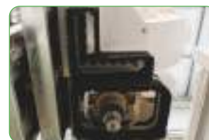
Bloc de găurire cu 10 burghie verticale - 4000 rpm
