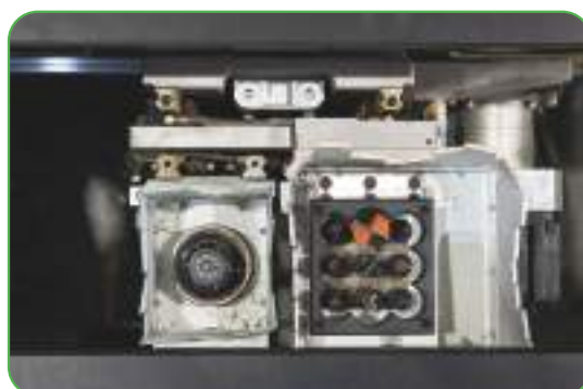
Bloc de găurire inferior 9 × 2 verticale
