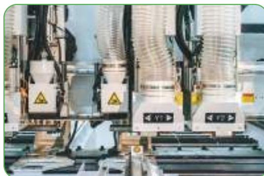
Bloc de găurire superior 19 × 4 verticale / X: 6 × 4 / Y: 4 × 4
